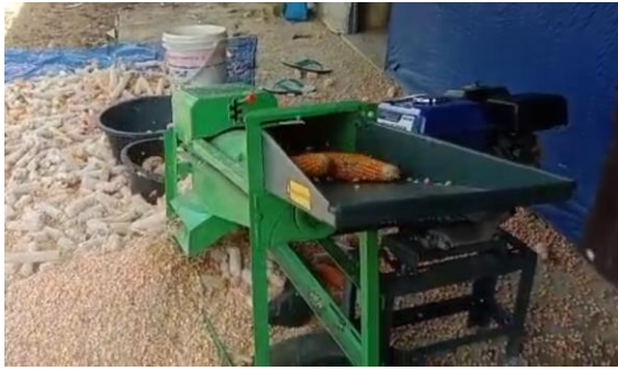
Gambar 162. Perontokan jagung menggunakan mesin, serta butir jagung hasil rontokan
